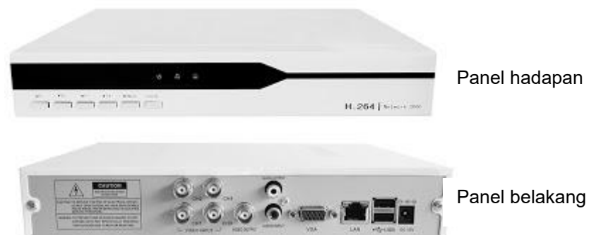
Rajah 21 DVR sebuah CCTV panel hadapan dan belakang
